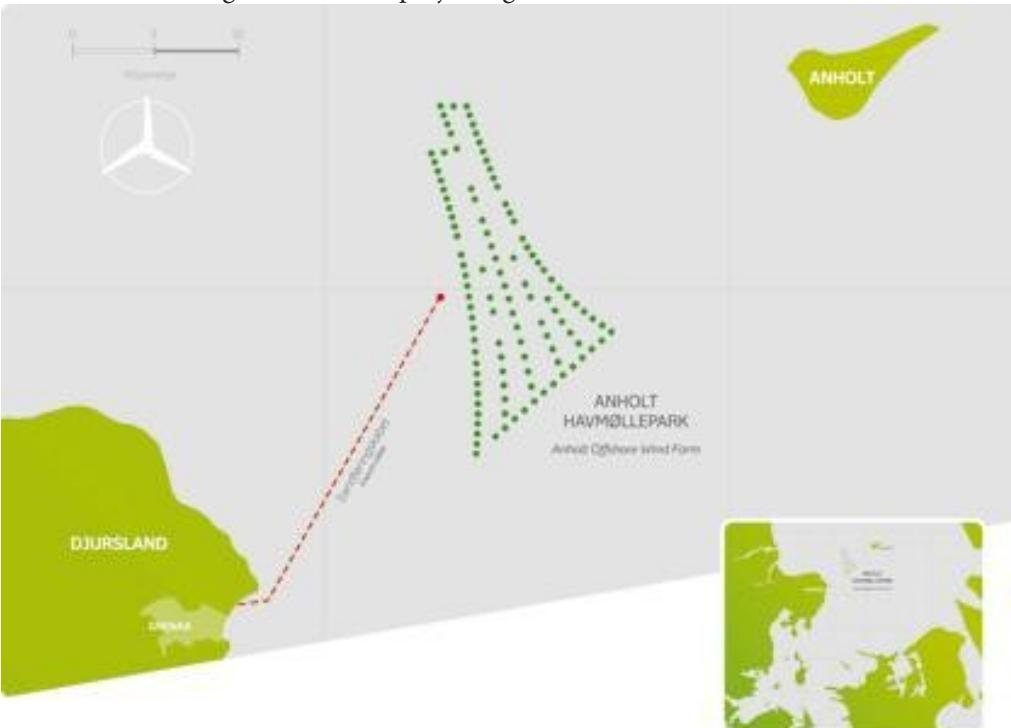
Parken forventes at være færdig i løbet sommeren 2013 og vil så have taget tre år at opføre. Der opsættes Siemens SWT-3,6-120 vindmøller med en kapacitet på 3,6 MW, hvilket giver en samlet kapacitet på 400 MW og det forventes at kunne producere el til 400.000 hustande.
